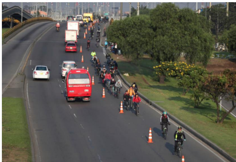
Figura 3 – Implantação de 117km de ciclovias temporárias em Bogotá com limitação por cones
