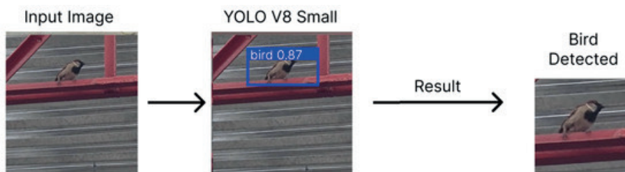
Figura 3 - Descripción gráfica del proceso de identificación de aves utilizando YOLOv8 Small.
