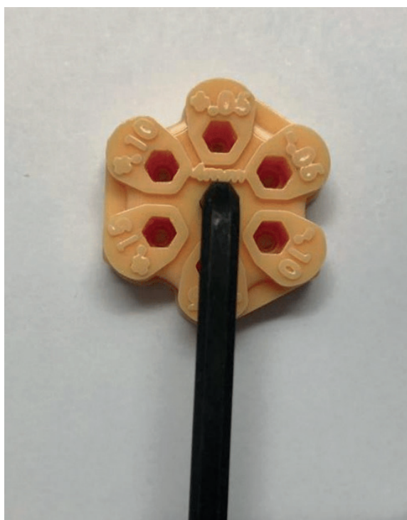
Figura 21: Hexágono do teste de calibração da impressão no ponto “central”, o ideal.
