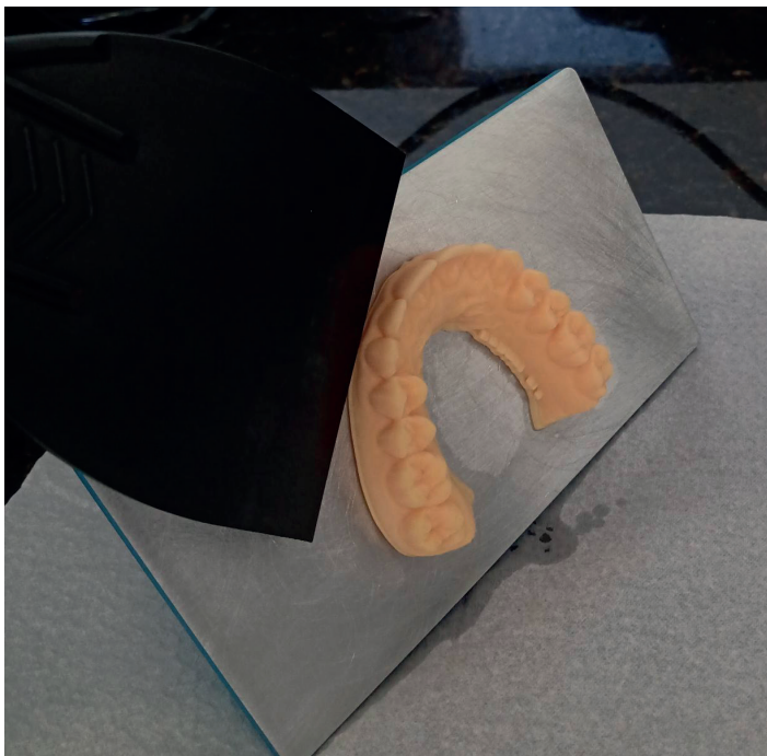
Figura 47: Descolamento da peça impressa da plataforma da impressora.
