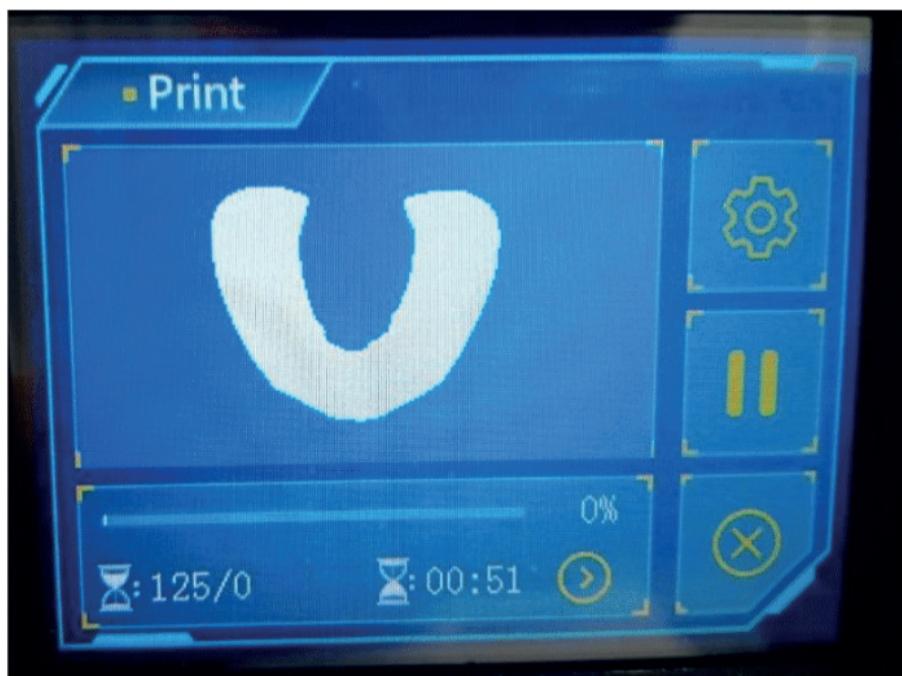
Figura 43: LED de impressão. Representação do que está sendo polimerizado.
