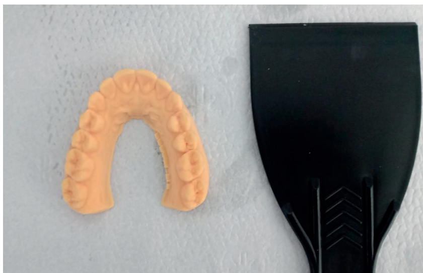
Figura 48: Material descolado com o auxílio da espátula plástica.
