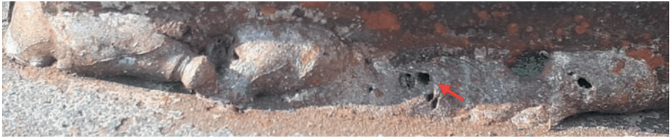
Figura 43: Porosidade em um cordão de solda
