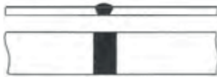
Figura 38: Representação solda de entalhe para ligação de topo
