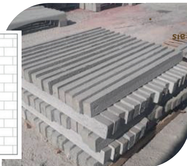
Figura 51 – Execução de vergas e contravergas em alvenarias. Fonte: google imagens.
