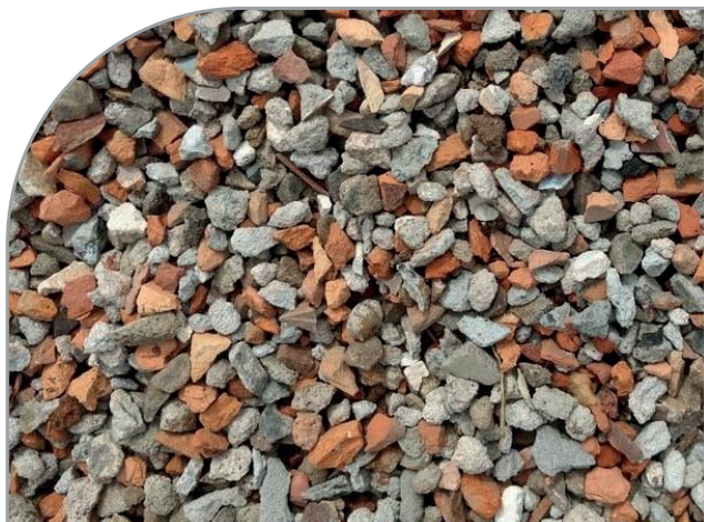
Figura 3 – Brita reciclada mista (ARM graúdo) (à esquerda). Contém partículas cimentícias e de cerâmica vermelha (em maior quantidade), de 10 a 40%, usualmente. Pode conter impurezas, quando o resíduo não é bem triado na origem. (à direita) Bica corrida (ARM) (dimensão inferior a 50 mm). Fonte: google imagens.
