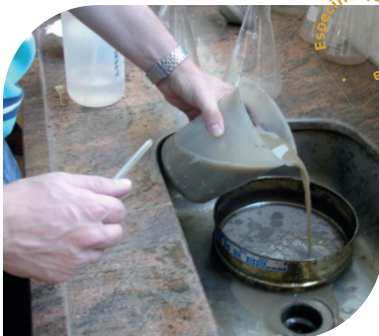
Figura 14 – Ensaio de lavagem e determinação dos finos nos agregados, naturais ou reciclados. Usa-se a peneira de abertura de malha de 0,075 mm. Fonte: google imagens.
