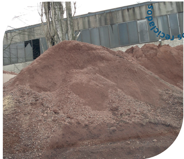
Figura 8 – Solos (finos naturais) obtidos por escalpe, antes da britagem do RCD. É comercializado como um produto secundário das usinas de reciclagem, mas que, dependendo do RCD recebido na usina, pode chegar a representar quase metade da massa de entrada das usinas.
