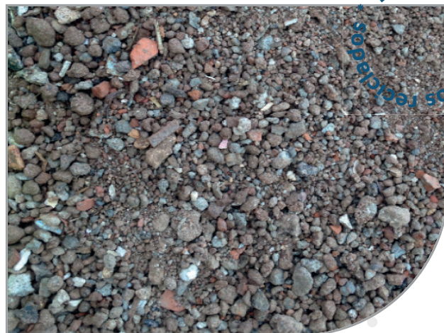
Figura 3 – Brita reciclada mista (ARM graúdo) (à esquerda). Contém partículas cimentícias e de cerâmica vermelha (em maior quantidade), de 10 a 40%, usualmente. Pode conter impurezas, quando o resíduo não é bem triado na origem. (à direita) Bica corrida (ARM) (dimensão inferior a 50 mm). Fonte: google imagens.
