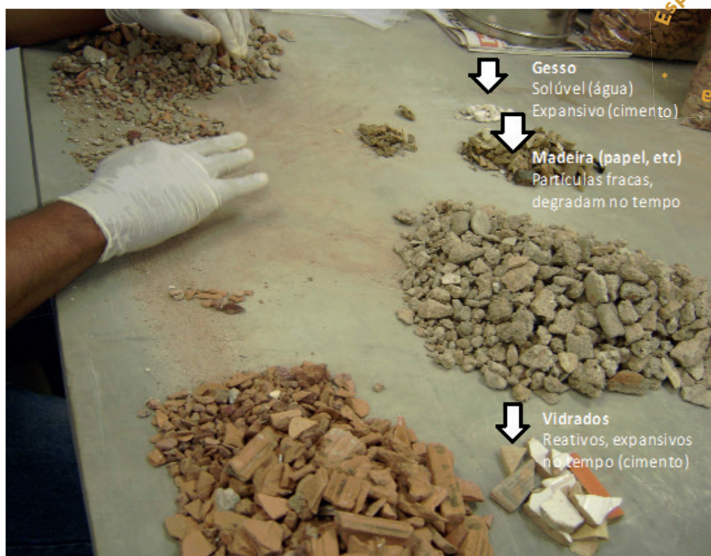
Figura 11 - - Classificação dos materiais presentes nos agregados reciclados pelo ensaio de catação. O método só é aplicado na fração graúda (acima de 4,8 mm). Fonte: S. C. Angulo.
