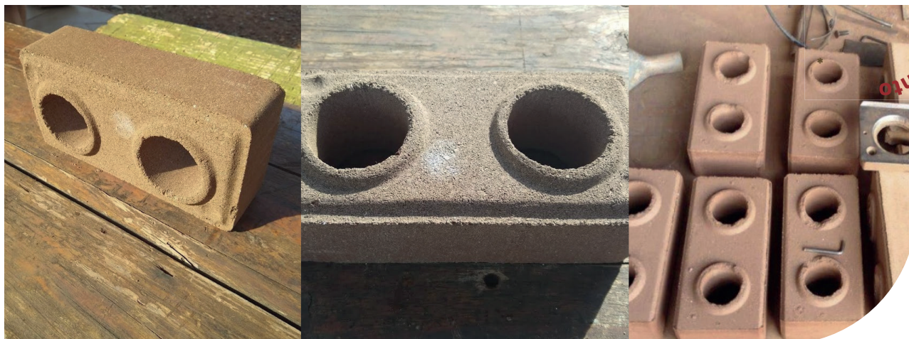
Figura 61 -Tijolos de solo cimento podem conter agregados reciclados. Fonte: ABRECON.
