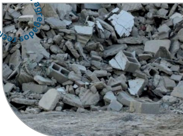
Figura 4 – Resíduo cimentício em usina de reciclagem (à esquerda), constituído por mistura de tipos de argamassas e concretos, diversos não estruturais. Resíduo cimentício de obra (à direita), com quebras de blocos de concreto e sobras da execução de serviços de argamassa (maior concentração de fração fina no material). Fonte: google imagens.
