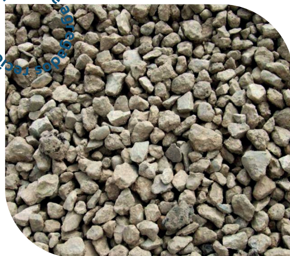
Figura 7 - Brita reciclada de concreto (ARCO graúdo). Pode conter, em pequena quantidade, alguns materiais secundários (como cerâmica vermelha, ou impurezas). A partícula contém cimento endurecido e agregados naturais (areia de rio) e artificiais (rochas britadas). Fonte: google imagens.
