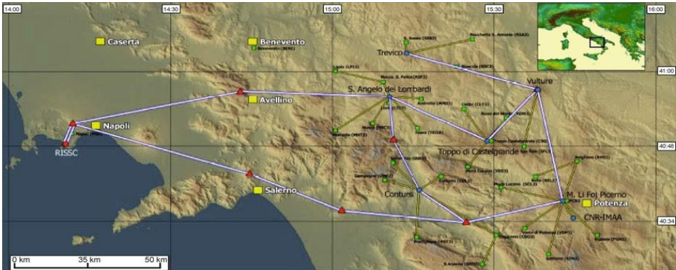
Figura 3. Sistema de alerta temprana en el Sur de Italia. Topología del sistema de comunicación ISNet muestra la configuración de estrella de la red sísmica. Imagen obtenida de Mouans-Sartoux, F (2011) con ejemplo de triangulación.
