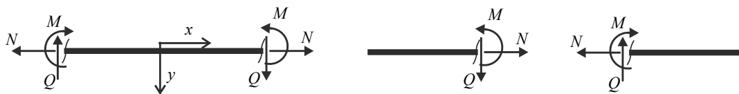
Figura 3.15: Convenção de sinal para os esforços solicitantes
