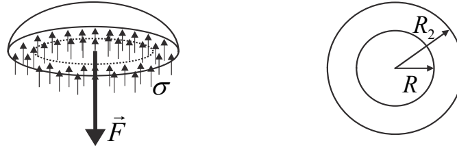
Figura 5.10: Tensão de esmagamento
