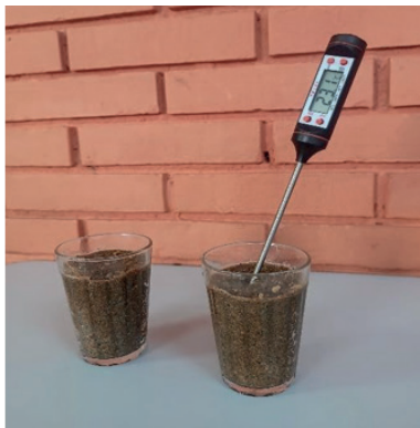
Figuras 14, 15 e 16 - Desenvolvimento das medições de temperaturas antes da exposição ao Sol
