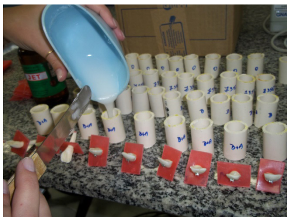
Figura 2 - Resina acrílica sendo condicionada nos tubos PVC.
