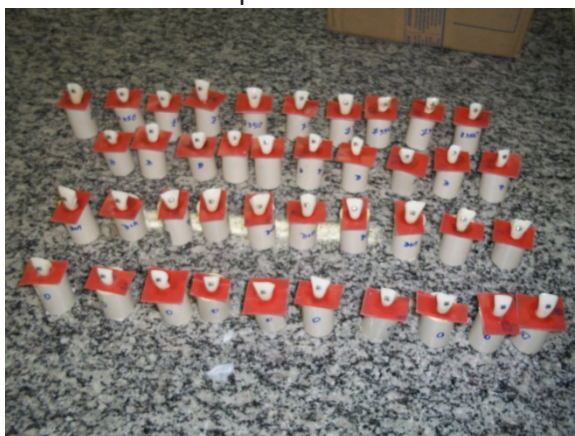
Figura 3 - Elementos dentários sendo posicionados em tubo PVC com resina acrílica.
