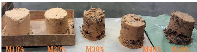
Figura 2: Corpos de prova com trincas
