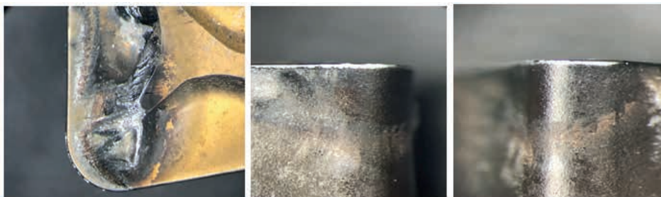
Figura 5 – Desgaste no inserto com revestimento de nitreto de titânio no torneamento do aço SAE1045
