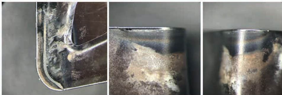
Figura 6 – Desgaste no inserto com revestimento de óxido de alumínio no torneamento do aço SAE1045
