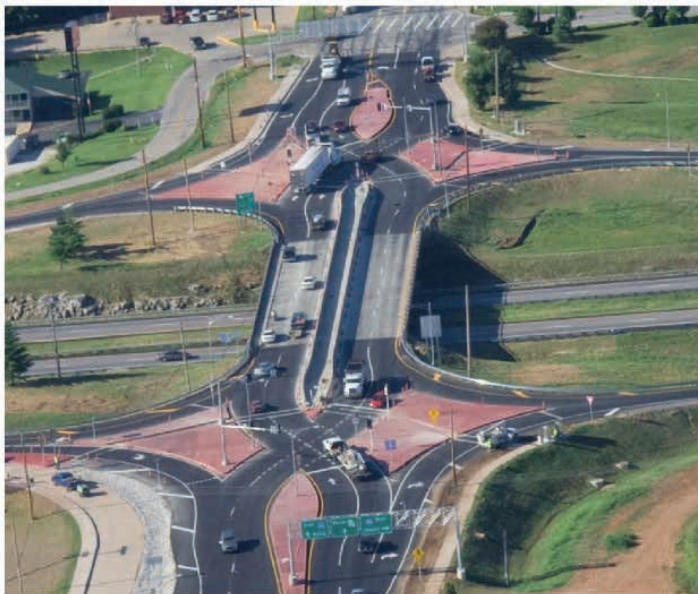
Figura 4: Primeira DDI construída nos Estados Unidos (MODOT, 2013).
