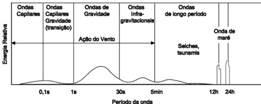
Figura 2. Caracterização das ondas por faixa de frequência
