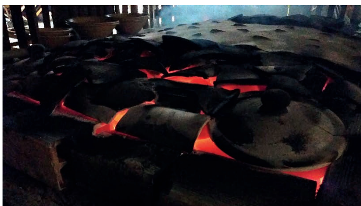
Figura 3. Coloração das peças na finalização do processo de cozimento.
