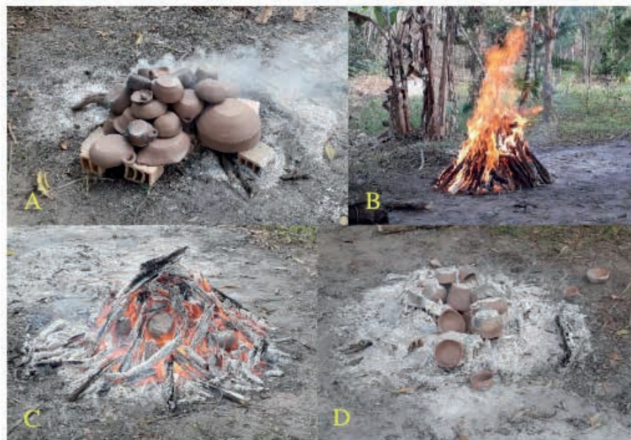
Figura 1. Cozimento de cerâmica por coivara, ou a “cêú aberto”, na Vila Quiera, em Bragança, PA. A) Empilhamento das peças; B) Cozimento com lenha sobrepostas as peças; C) Finalização do cozimento; D) Retirada das peças ainda quentes.
