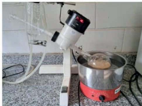
Figura 02- Sistema de gelatinização do mosto de batata doce in natura
