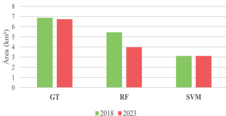
Figura 9 - Comparação da área total da classe 'árvore' obtida por vetorização manual (GT - ground truth) e pelos algoritmos RF e SVM, para a região de alta densidade urbana em Presidente Prudente - SP.
