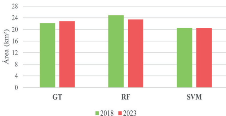
Figura 10 - Comparação da área total da classe 'árvore' obtida por vetorização manual (GT - ground truth ) e pelos algoritmos RF e SVM, para a região de alta densidade urbana em Presidente Prudente - SP.
