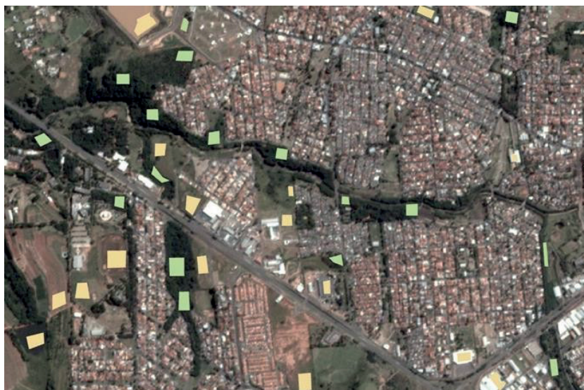
Figura 3 - Vetorização manual dos polígonos representando as classes 'árvore' (verde) e 'outra' (amarelo) para treinamento/validação e teste dos algoritmos RF e SVM.
