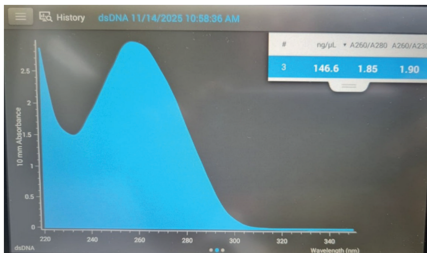
Figura 2. Espectro de isolado de DNA com alto nível de pureza.
