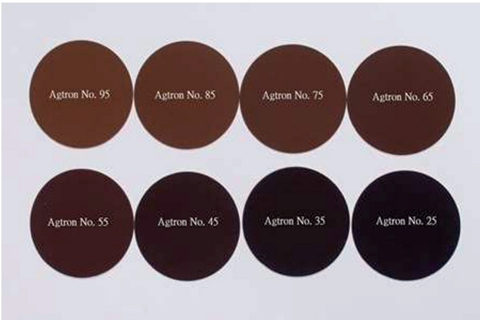
Figura 1. Classificação por meio de coloração de café torrado em sistema de disco Agtron.
