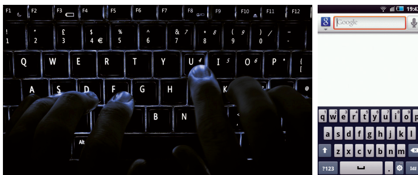
Figura 32 – Teclado convencional (mais sujeito à ação de keyloggers ) e teclado virtual, que oferece maior proteção
