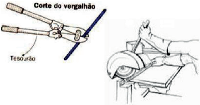
Figura 27 - Procedimento de corte das barras de ferro
