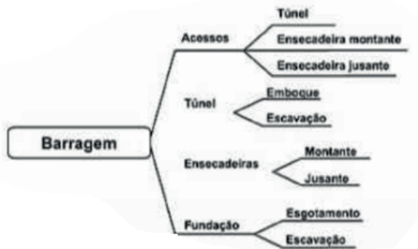
Figura 74 - Atividades de execução da barragem
