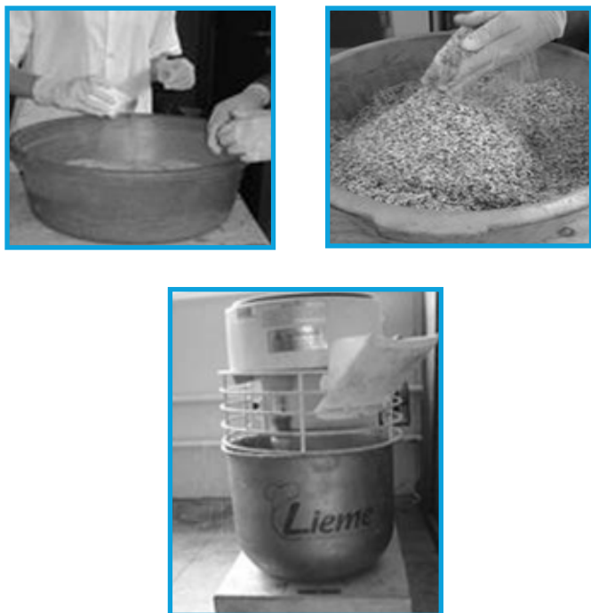
Figura 3 Adição de poliol (a), homogeneização manual (b) homogeneização em misturador elétrico (c)
