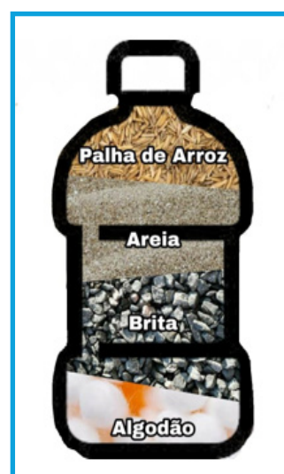
Figura 1. Ilustração da composição do filtro orgânico elaborado.
