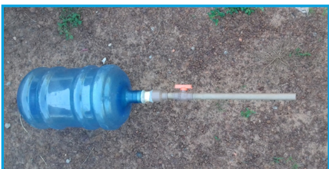
Figura 4 – Equipamento construído para a captação de biogás.
