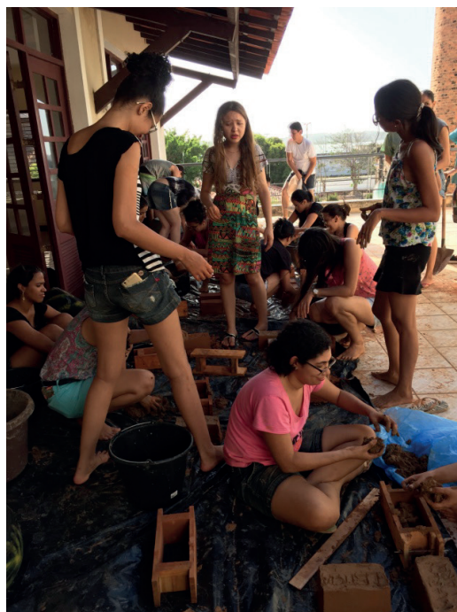
Figura 9 – Manufatura do adobe
