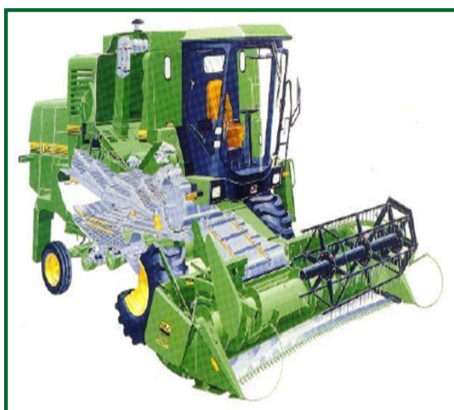
Figura 5 – Colhedora automotriz combinada equipada com sistema radial de trilha de grãos
