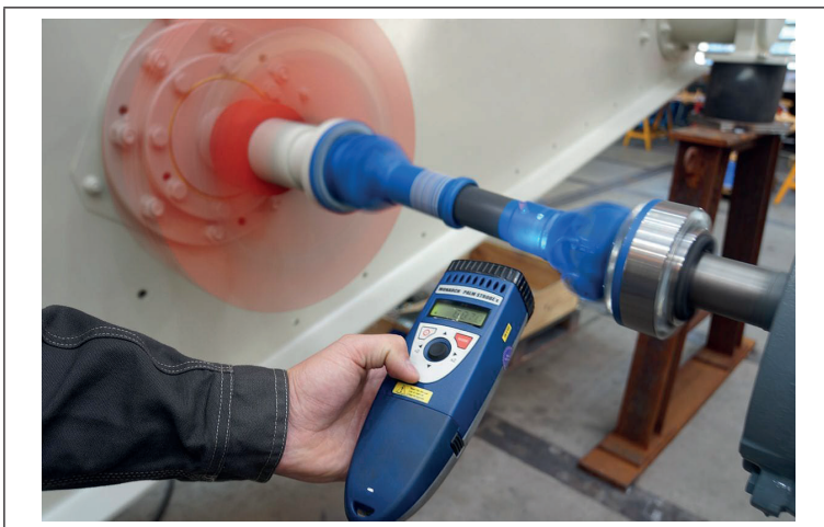
Foto 18: Estroboscópio sendo utilizado na análise de transmissão.
