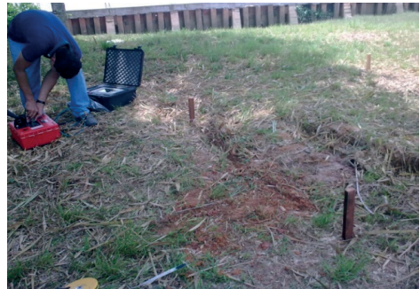
Figura 7. Procedimento de campo para cálculo da velocidade. Macaco, envolto em saco plástico, enterrado em 300NE afastado 3 m da pista.
