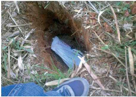
Figura 7. Procedimento de campo para cálculo da velocidade. Macaco, envolto em saco plástico, enterrado em 300NE afastado 3 m da pista.
