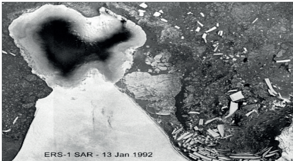
Figura 14 – Imagem adquirida pelo satélite ERS-1 em 13-01-1992 mostrando o início da desintegração da plataforma Wilkins, na península Antártida, que de fato se efetivou em 2008. São notáveis as áreas brancas, de gelo mais espesso, demonstrando alta reflectância de REM, o gelo mais fino em cinza, e a água do mar em tom mais escuro.
