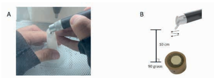
Figura 4 - Jateamento com óxido de alumínio (distância padronizada pelo dispositivo plástico)
