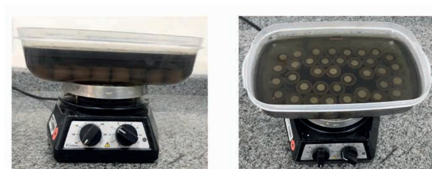
Figura 6 - Amostras posicionadas sobre o agitador magnético (Fisatom 752A, Fisatom Equipamentos Científicos Ltda., São Paulo, Brasil)
