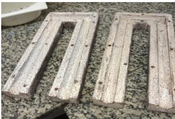
Figura 2 – Molde utilizado no vazamento.
