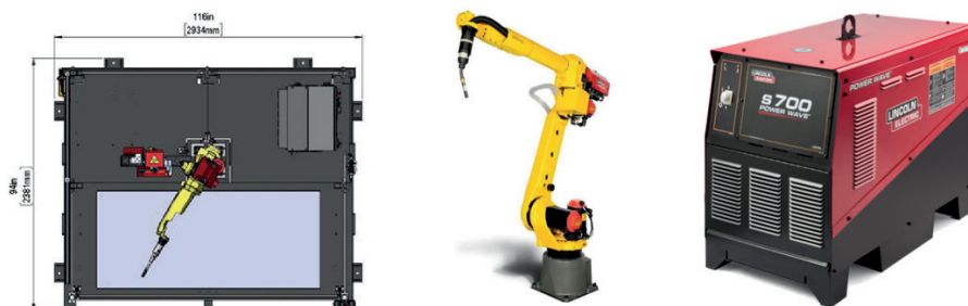
Figura 2 - Célula Lincoln AUTO-MATE® SS e Robô Fanuc Arc Mate 120iC e fonte PW S700.
