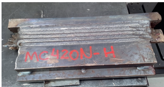
Figura 4 - Peça soldada com o arame "A" (MC420N-H) finalizada.
