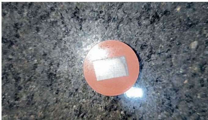
Figura 6 - Corpo de prova embutido.
