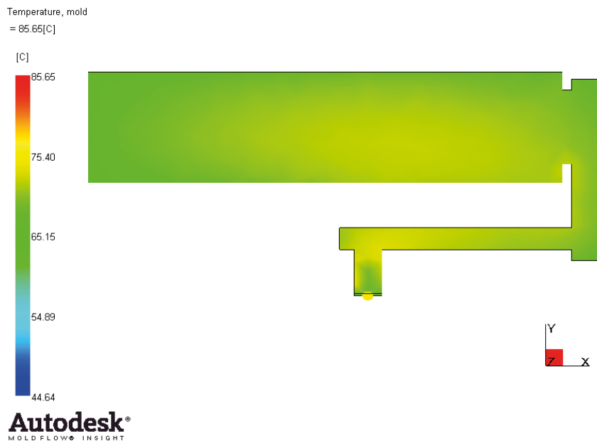
Figura 43 - Resultado da temperatura nas paredes da cavidade na simulação da PA66 em molde metálico, após a extração.
