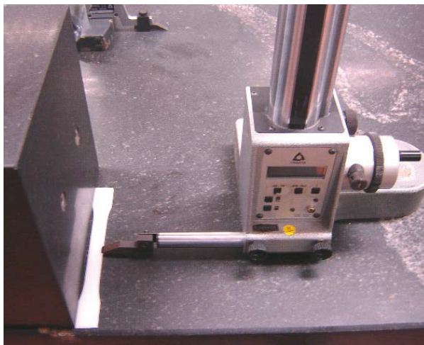
Figura 24 - Medição do empenamento através da flecha do corpo de prova.
