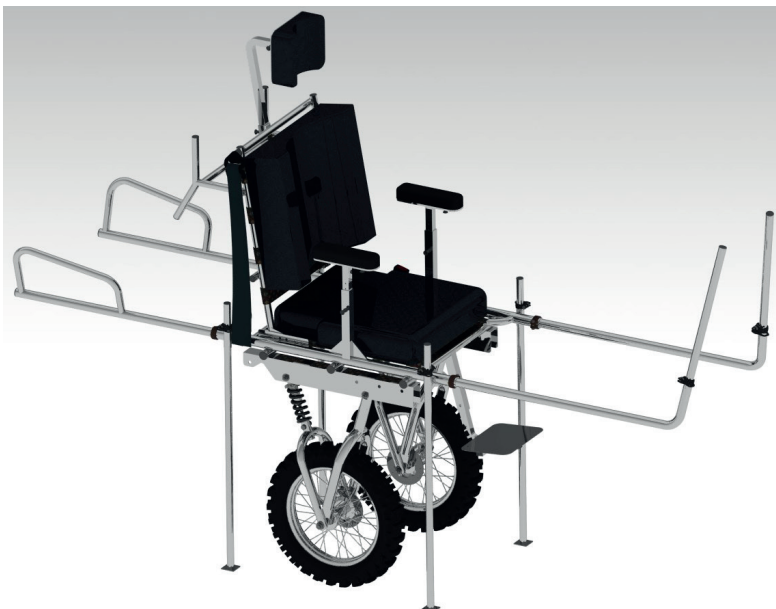
Figura 3 – Cadeira configurada para PcD e carregadores P95.
