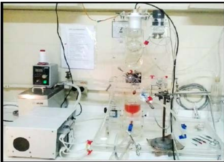
Figura 1: Esquema do Sistema de Perfusão Langendorff
