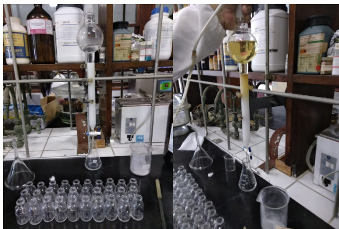
Fig.16: Vidraria utilizada na cromatografia de coluna.
