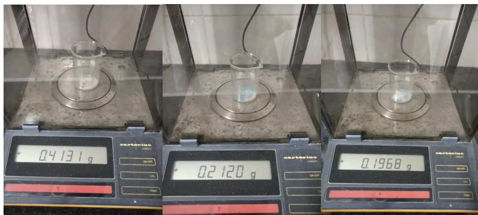
Fig.8: Pesagem dos reagentes da mistura 1 para a cicloadição da 2-clorofenilazida: ácido ascórbico, \text{CuSO}_4 \cdot 5\text{H}_2\text{O} e \text{NaHCO}_3 .
