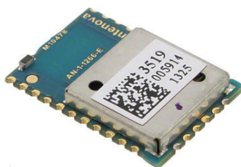
Figura 5: El módulo GPS M10478 GPS de Antenova integra el sistema de antenna.
