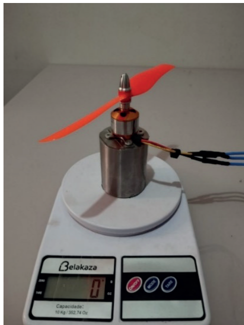
Figura 4 - Medição do empuxo gerado pelos motores.
