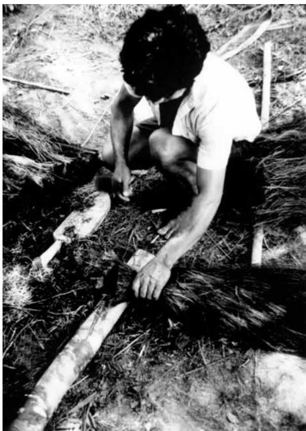
Figura 92 Piaçabeiro cortando e acertando a piaçaba, com o uso do facão e da “pá”, para a elaboração das piraíbas. Rio Xié, 1992.
